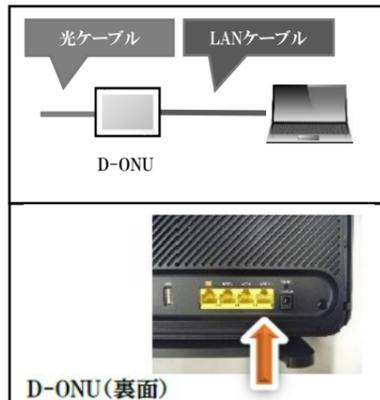
D-ONU裏面のLAN1ポートとパソコンのLANポートを付属のLANケーブルで接続してください。
